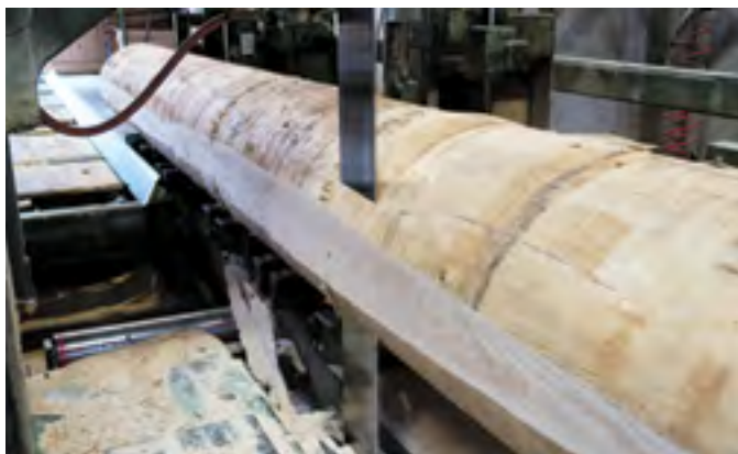
Unsere nachhaltige Ressource Holz: im Bild ein Rundholzeinschnitt in einem Kleinsägewerk (Foto: LK Vorarlberg).
